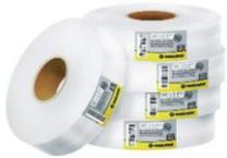
**Cinta de papel:** De celulosa, microperforada, de 50mm de ancho y premarcada en el centro. Se utiliza para el tomado de juntas entre placas y para resolver ángulos formados por dos superficies construidas con placas Durlock®.
